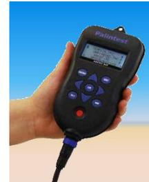
Das Multi-Parameter-Sonden-System Macro 900 wurde zur Kontrolle von Grundwasser, fließende und stehende Gewässer sowie für Messungen in der Landwirtschaft und Umweltschutz entwickelt. Das Gerät ist wasserdicht (IP 67) und kann bis zu 2000 Messungen speichern. Mit der zusätzlichen Hilfe der atmosphärischen Druck-Messung können noch präzisere Messungen des gelösten Sauerstoffes vorgenommen werden. Das Gerät verfügt außerdem über ein integriertes GPS.
