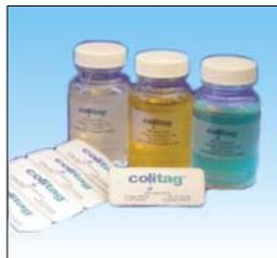
Test-Substrat in die mit 100 ml Wasserprobe befüllte Küvette geben, 24 Stunden in den Brutschrank geben, anschließend Ergebnis anhand der Farbreaktionen ablesen! Eine gelbe Verfärbung der Probe bestätigt die Präsenz von Coliformen Keimen, Vorhandene E-Coli werden mit Hilfe einer UV-Lampe (siehe unten) sichtbar gemacht. (1 Substrat-Pack pro Test, Lieferung ohne Küvetten)
